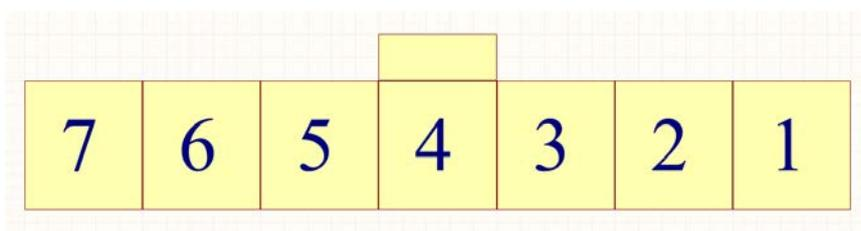
**Шина DATA может находиться на 2,3,5 или 6 контакте семи проводного разъема блока штатного иммобилайзера на рулевой колонке в зависимости модели автомобиля.**
