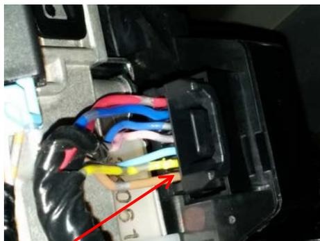
**Honda CRV** (с 2007 по 2012 год) код модели 2613. Подключение под рулевым кожухом - пятый пин, зеленый провод.
