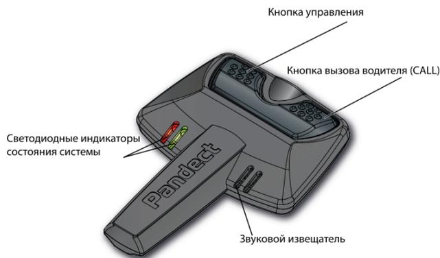
Функции иммобилайзера реализованы в RF-модуле системы. RF-модуль взаимодействует с противоразбойными метками и радиоуправляемыми реле блокировки на частоте 2,4ГГц. Изменение настроек иммобилайзера, программирование реле и меток производится в меню программирования RF-модуля. Для аварийной деактивации и входа в режим программирования иммобилайзера используется секретный PIN-код.
