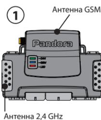
Рекомендуется располагать базовый блок системы под «торпедой» или в районе приборной панели разъемными вниз. При этом обеспечьте жесткое крепление к кузову автомобиля или деталям непосредственно связанным с кузовом. Встроенная GSM и 2,4 GHz-антенны не должны экранироваться металлическими элементами конструкции автомобиля. В случае если место установки не обеспечивает устойчивого приема сигнала сотовой сети, необходимо использовать внешнюю GSM-антенну.
