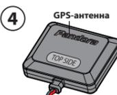
GPS/GLONASS-приемник рекомендуется располагать вблизи лобового стекла под панелью приборов встроенная в GPS/GLONASS-приемник антенна должны быть направлена в сторону остекления. Ориентация антенны в корпусе указана в инструкции к GPS/GLONASS-приемнику. Запрещается экранировать! Пластиковые панели внутренней отделки кузова автомобиля не являются экраном.
