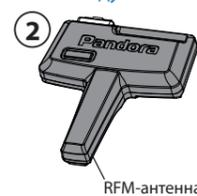
Рекомендуется располагать RF-модуль на лобовом стекле. При этом обеспечьте расстояние от металлических частей кузова до RF-антенны не менее 7 см. Учтите, что наличие встроенного обогрева лобового стекла может снизить дальность работы радиоканала.
