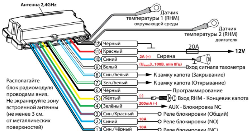
Модуль моторного отсека RHM-06 предназначен для установки на автомобили с напряжением бортовой сети 12V. Модуль предназначен для скрытной установки в подкапотном пространстве автомобиля. Запрещается установка модуля вблизи с выпускным коллектором, а так же в места с повышенной влажностью. При монтаже устройства избегайте экранирования встроенной антенны на 2,4GHz металлическими частями кузова.
