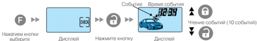
Для выхода из режима просмотра необходимо нажать кнопку 1 сек либо выход произойдет автоматически через 60 сек. Выход из режима просмотра произойдет также если на брелок придет извещение о событии на автомобиле.
