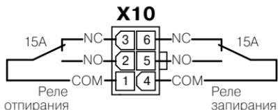
Изображена схема подключения реле, встроенных в базовый блок
