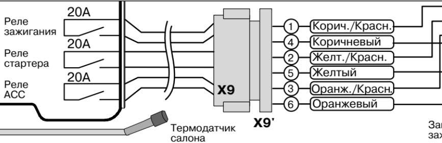
Схема подключения автосигнализации
