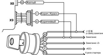
Типовая схема подключения к замку зажигания (параллельно)
