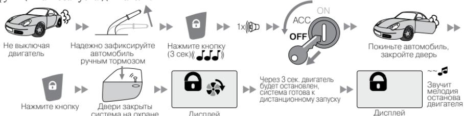
Если разрешен подуровень II-3.8 «Автоматическое включение программной нейтрали», то процедура «программная нейтраль» будет автоматически выполняться при поднятии ручника. Неисполнение процедуры «программная нейтраль» влечет за собой отказ системы выполнять команды дистанционного и автоматического старта двигателя.
