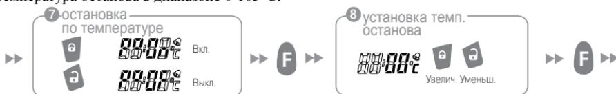
Максимальная температура останова двигателя, во избежание установки недопустимого значения пользователем, может быть ограничена программно (подуровни II-6.2.-6.4 меню программирования руководства по монтажу) до 60, 80 или 105°C ( заводская установка 105°C).
