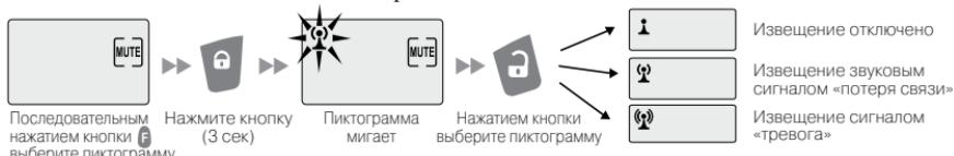
Для выхода из режима и сохранения нажмите кнопку «3» в течение 1 сек., или выход произойдет автоматически через 10 сек.
