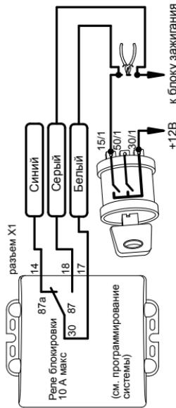
Пример схемы блокировки нормально замкнутым реле (в меню проограммирования установка типа контактов НЗ)
