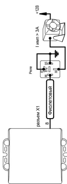
Схема подключения сирены (нейджера)
