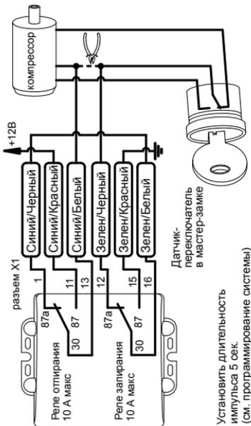
Установить длительность импульса 5 сек (см. программирование системы)
