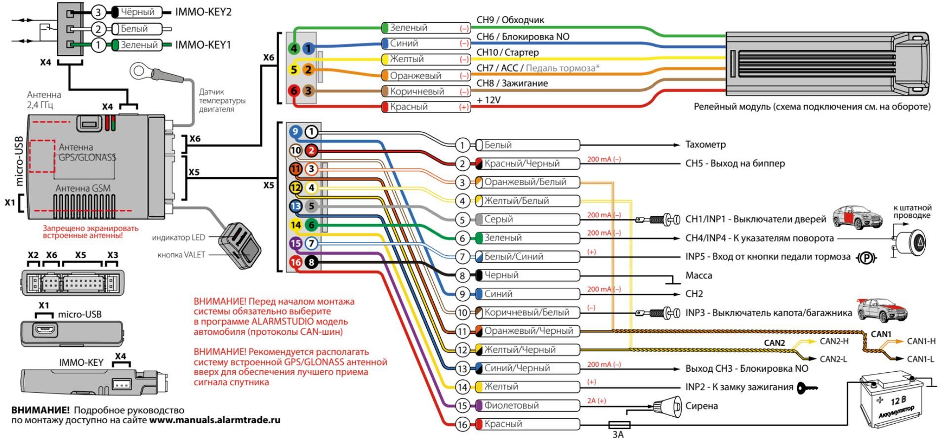
**ВНИМАНИЕ!** Перед началом монтажа системы обязательно выберите в программе ALARMSTUDIO модель автомобиля (протоколы CAN-шин)
