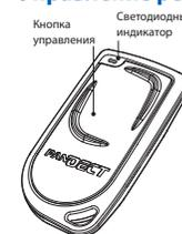
Для включения или отключения режима охраны, находясь в зоне действия радиоканала (в радиусе до 5м от автомобиля) нажмите кнопку на брелоке метке. Система производит защищённый шифрованный (шифрование AES-128) диалоговый высокоскоростной обмен кодами авторизации в частотном диапазоне 2,4 ГГц на одном из 125 каналов.
