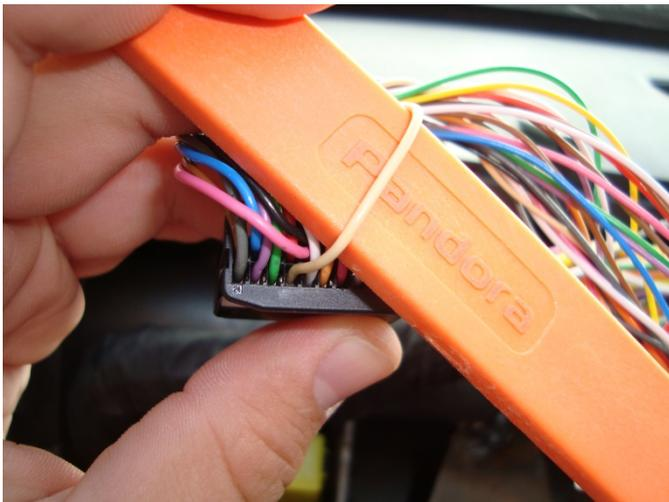
Подключение контроля работы двигателя
