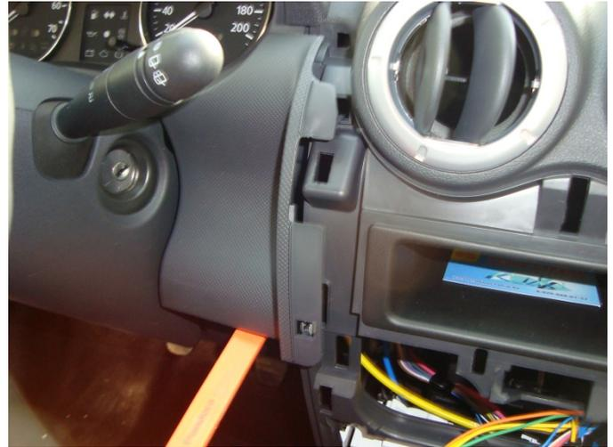
Для подключения к кнопке аварийки и центрального замка требуется снять пластиковую накладку, накладка крепится на пластиковых клипсах.
