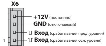
Входы отрабатывают импульсы отрицательной полярности длительностью не менее 0,3 сек.
