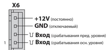
Входы обрабатывают импульсы отрицательной полярности длительностью не менее 0,3 сек.
