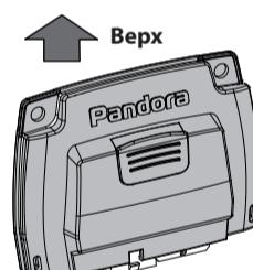
Корпус модуля TCM-6 частично герметизирован, предназначен для монтажа в салоне автомобиля. Рекомендованное расположение базового блока указано на рисунке. Закрепляйте базовый блок винтами-саморезами, входящими в комплект, либо пластиковыми стяжками, либо при помощи двухсторонней липкой ленты на полимерной вспененной основе.
