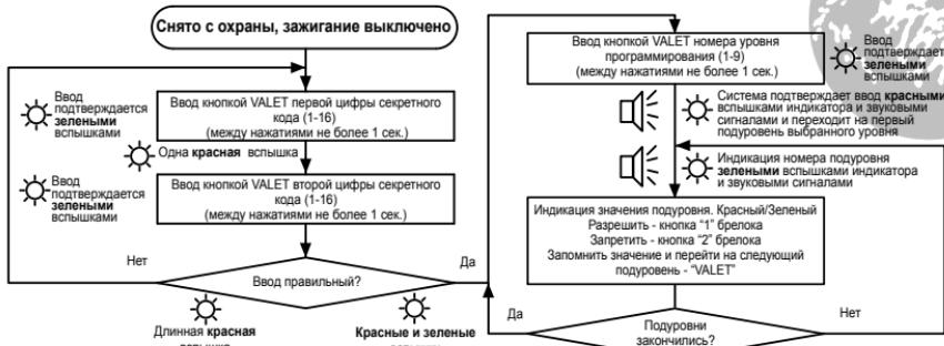
Выключение зажигания на любом из этапов - выход из режима программирования
