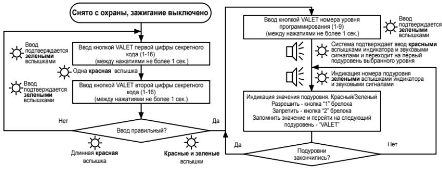
Включение зажигания на любом из этапов - выход из режима программирования
