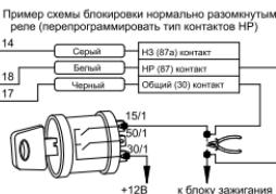
Пример схемы блокировки нормально разомкнутым реле (перепрограммировать тип контактов НР)
