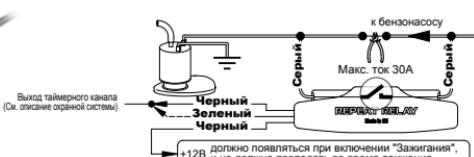
Для максимального уровня противоугонной стойкости используйте возможность подключения однопроводного кодового реле скрытой блокировки с динамическим кодом BM-102 (приобретается отдельно).
