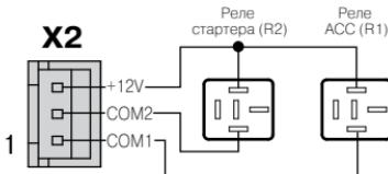
Использовать только для версии с дистанционным стартом двигателя (на выводе «3» +12V присутствует постоянно)
