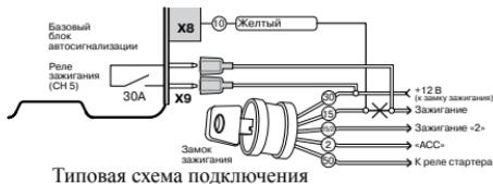
Типовая схема подключения к замку зажигания (с разрывом)
