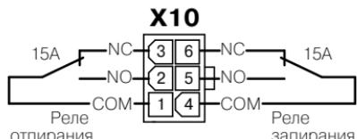
Изображена схема подключения реле встроенных в базовый блок
