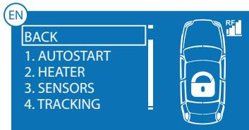
2. ПОДОГРЕВ ДВ. / HEATER - управление предпусковым подогревателем двигателя
