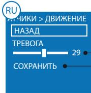
шкала регулировки чувствительности датчика движения
