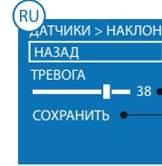
шкала регулировки чувствительности датчика наклона
