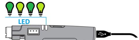
10. По завершению загрузки отсоедините USB кабель – базовый блок перейдет в обычный режим работы.
