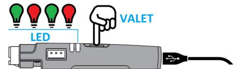
7. **ОБЯЗАТЕЛЬНО! Дождитесь мигания зелёного светодиода LED (зеленая вспышка раз в секунду).** Отключите USB-интерфейс только после начала мигания зеленого светодиода.
