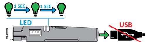
8. Снова при зажатой кнопке VALET произведите подключение к базовому блоку через USB-интерфейс и отпустите кнопку сразу после подключения.
