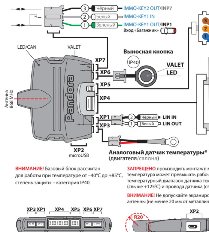
**ВНИМАНИЕ!** Базовый блок рассчитан для работы при температуре от  $-40^{\circ}\text{C}$  до  $+85^{\circ}\text{C}$ , степень защиты – категория IP40.
