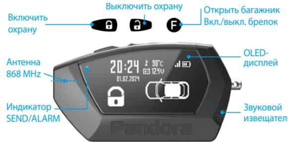
! В момент поставки БРЕЛОК СИСТЕМЫ НАХОДИТСЯ В ВЫКЛЮЧЕННОМ СОСТОЯНИИ, ВКЛЮЧИТЕ ЕГО В СООТВЕТСТВИИ С ИНСТРУКЦИЕЙ. Брелок является унифицированным средством управления. Работа брелока зависит от модели охранной системы и реализованных функций. При работе с брелоком, для достижения максимальной эффективности и максимальной дальности радиообмена, рекомендуется не закрывать пальцами рук зону встроенной антенны (см. рисунок).
