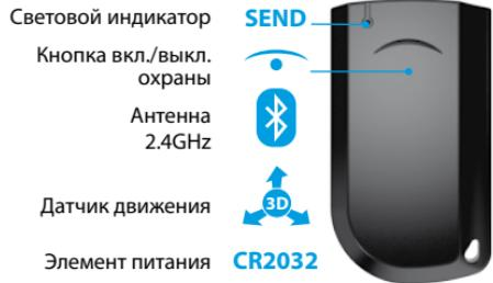
! Для корректной работы не рекомендуется располагать радиометку рядом с металлическими предметами, магнитными и электронными устройствами (магнитные и кредитные карты, телефоны, ключи, брелоки и т.д.). Не подвергайте радиометку воздействиям высоких температур, попадания влаги, сильным ударам. Рекомендуется располагать радиометку скрытно на пояске в отдельном чехле или в переднем кармане одежды.
