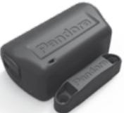
**Радиореле блокировки BTR-101** – периферийное устройство предназначено для управления блокировкой двигателя с учетом или без учета перемещения транспортного средства.
