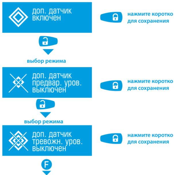
Для оперативной дистанционной регулировки зон дополнительного датчика короткими нажатиями кнопки **F** выберите подменю «РЕГУЛИРОВКА ДОПОЛНИТЕЛЬНОГО ДАТЧИКА ТРЕВОЖНЫЙ УРОВЕНЬ» или «РЕГУЛИРОВКА ДОПОЛНИТЕЛЬНОГО ДАТЧИКА ПРЕДУПРЕДИТЕЛЬНЫЙ УРОВЕНЬ».
