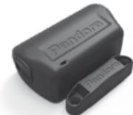
**Радиореле блокировки BTR-101** – периферийное устройство предназначено для управления блокировкой двигателя с учетом или без учета перемещения транспортного средства.
