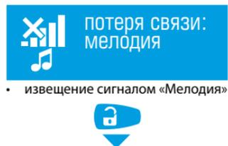
Извещение сигналом «Мелодия» производится однократно при включенном режиме охраны.
