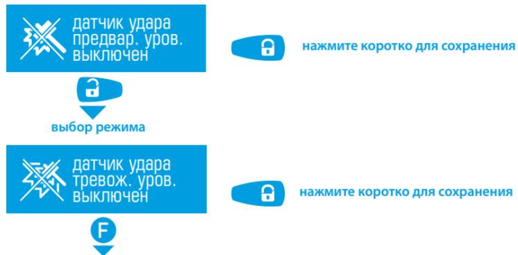
Для оперативной дистанционной регулировки зон датчика удара короткими нажатиями кнопки выберите подменю «РЕГУЛИРОВКА ДАТЧИКА УДАРА ТРЕВОЖНЫЙ УРОВЕНЬ» или «РЕГУЛИРОВКА ДАТЧИКА УДАРА ПРЕДУПРЕДИТЕЛЬНЫЙ УРОВЕНЬ». Изменение значения чувствительности датчика производится короткими нажатиями кнопок или . Для сохранения новых значений контроля датчика удержите кнопку на одну секунду. Для выхода из меню без сохранения настроек нажмите и удерживайте кнопку в течение 1 секунды.
