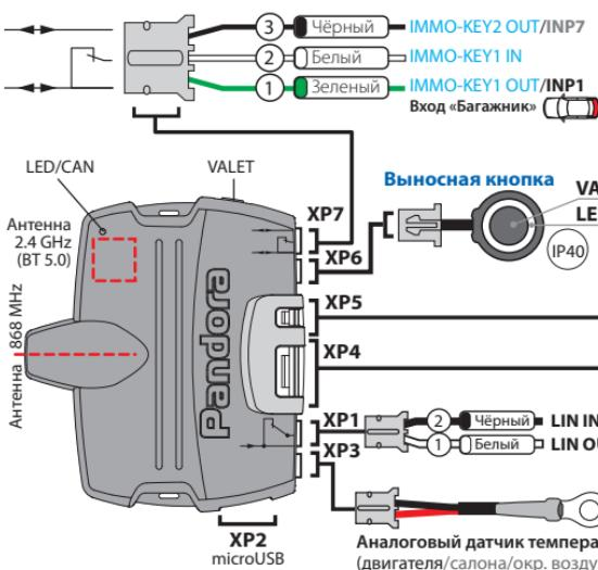
**ВНИМАНИЕ!** Базовый блок рассчитан для работы при температуре от  $-40^{\circ}\text{C}$  до  $+85^{\circ}\text{C}$ , степень защиты – категория IP40.
