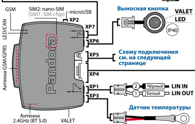
**ВНИМАНИЕ!** Базовый блок рассчитан для работы при температуре от  $-40^{\circ}\text{C}$  до  $+85^{\circ}\text{C}$ , степень защиты – категория IP40.
