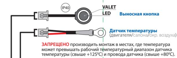
**ЗАПРЕЩЕНО** производить монтаж в местах, где температура может превышать рабочий температурный диапазон датчика температуры (свыше +125°C) и провода датчика температуры (свыше +80°C).
