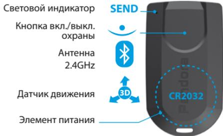
! Для корректной работы не рекомендуется располагать радиометку рядом с металлическими предметами, магнитными и электронными устройствами (магнитные и кредитные карты, телефоны, ключи, брелоки и т.д.). Не подвергайте радиометку воздействиям высоких температур, попадания влаги, сильным ударам. Рекомендуется располагать радиометку скрыто на пояске в отдельном чехле или в переднем кармане одежды.
